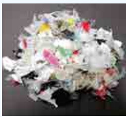
一次破碎ではがきぐらいの大きさに、二次破碎で切手ぐらいの大きさに砕く【フラフ】
