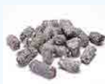
一次破碎ではがきぐらいの大きさに、二次破碎で切手ぐらいの大きさに砕く【フラフ】
