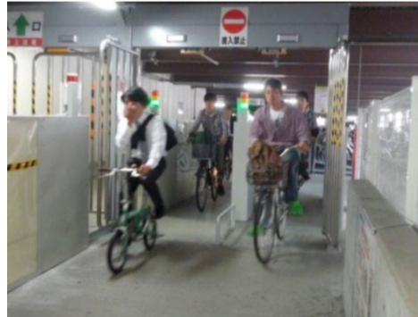
<ICタグを用いたゲートシステムを採用した駐輪場の例(滋賀県草津市)>
