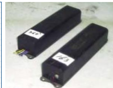
高濃度PCB使用安定器
