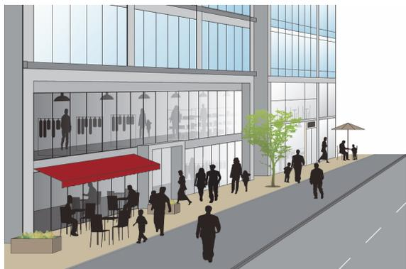
大きなガラスを用いたファサードでにぎわいのにじみ出しを図ったり、セットバックして滞留空間を設けて、まちに開かれた空間を創出
