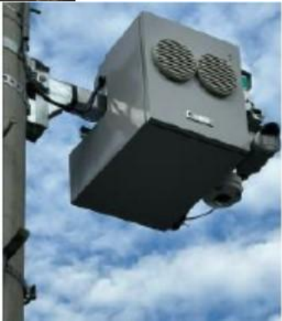
▲路車協調システムの設置箇所 交差点センサの設置イメージ▶
