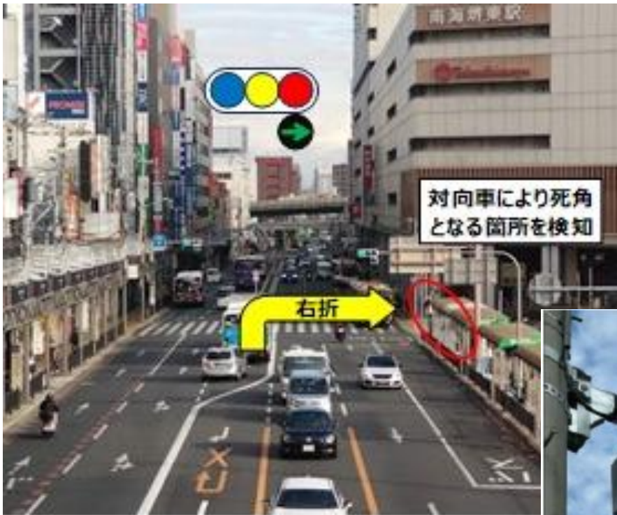
▲路車協調システムの設置箇所 交差点センサの設置イメージ▶
