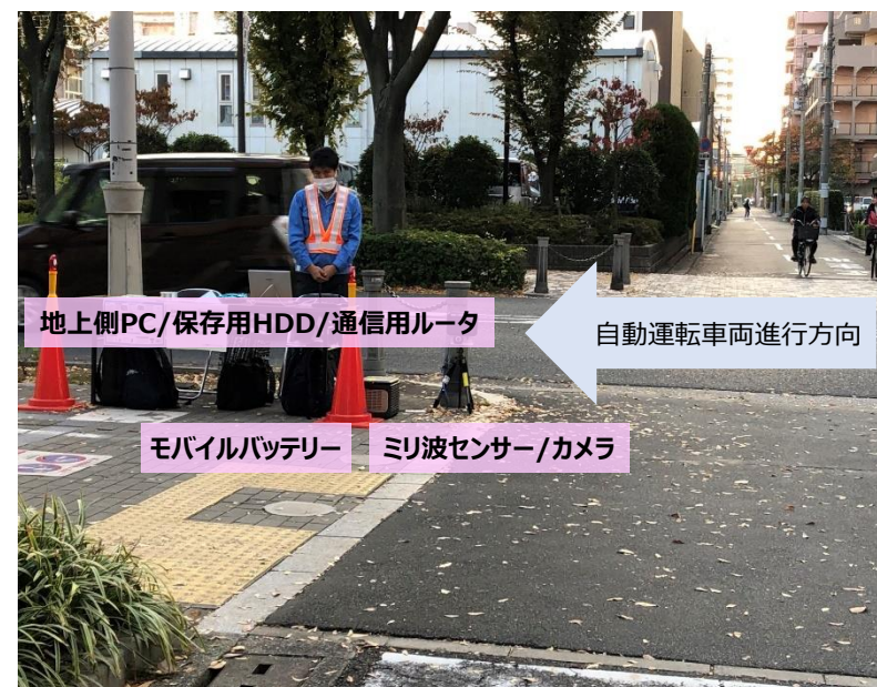
地上機器類の設置状況
