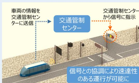
車両と信号が連動する交通信号優先システムの活用による定時性・速達性の確保
