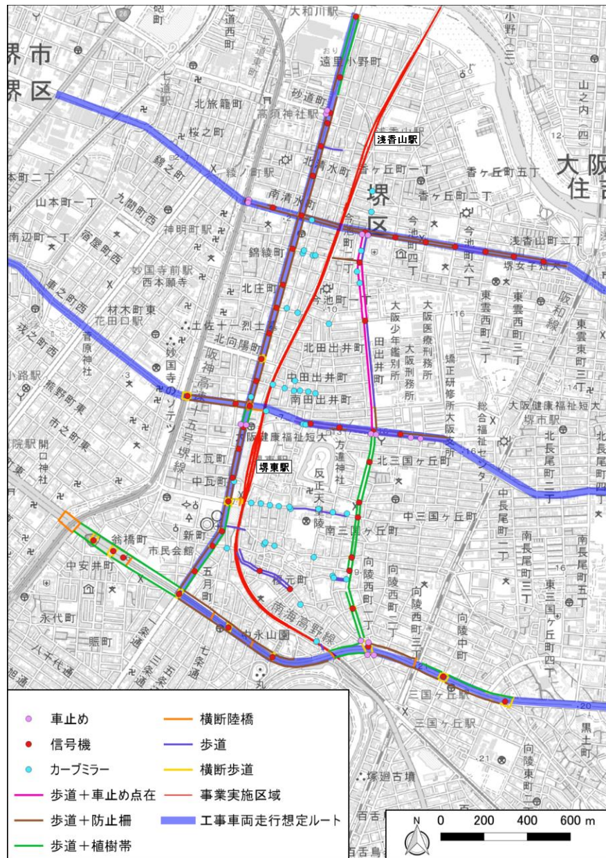
図 6.17-3 工事車両走行想定ルート及び安全施設等の設置状況
