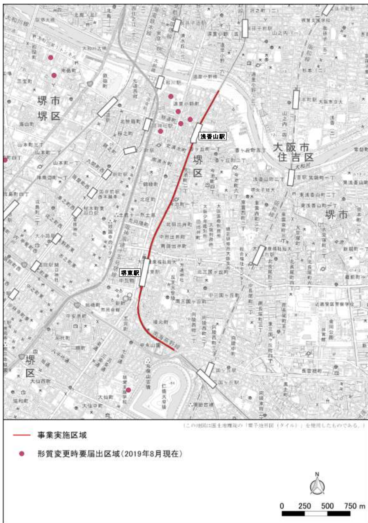
図 4.2-8 事業実施区域周辺における土壌汚染対策法に基づく形質変更時要届出区域
