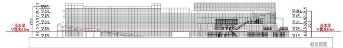
図 津波による浸水深と商業施設の建築高さ
