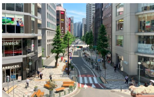
例：無電柱化された歩きやすい歩行空間 (神戸市 葺合南 54 号線)
