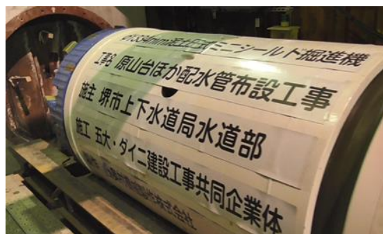
シールド工法による非開削工事状況
