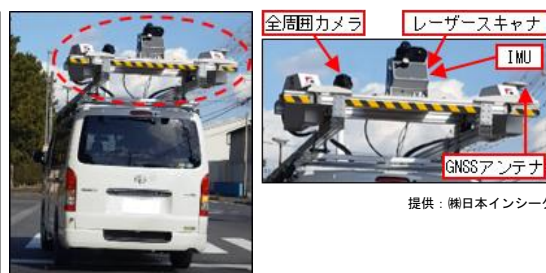
高性能カメラ等での 3次元計測による路面調査
