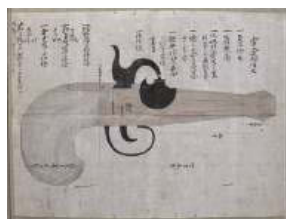
写真①井上関右衛門家に伝わる雷管式の銃の図面（個人蔵）
