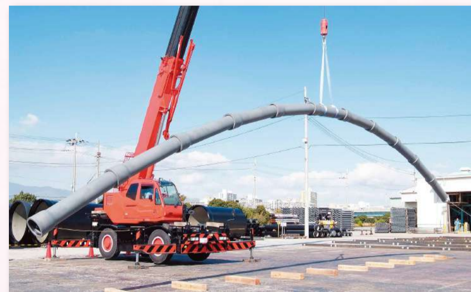
耐震管(ダクタイル鉄(ちゅう)鉄管) ※日本ダクタイル鉄管協会より
