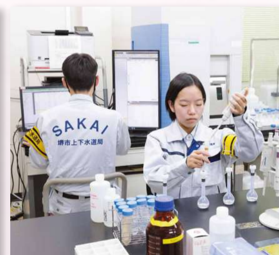
水道水に必要な51項目の水質検査を定期的を実施
