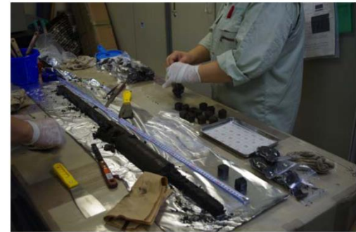
コアの一方は観察して、保管。 もう一方のコアは5～10cmで 分割し、各種分析用に分取する。
