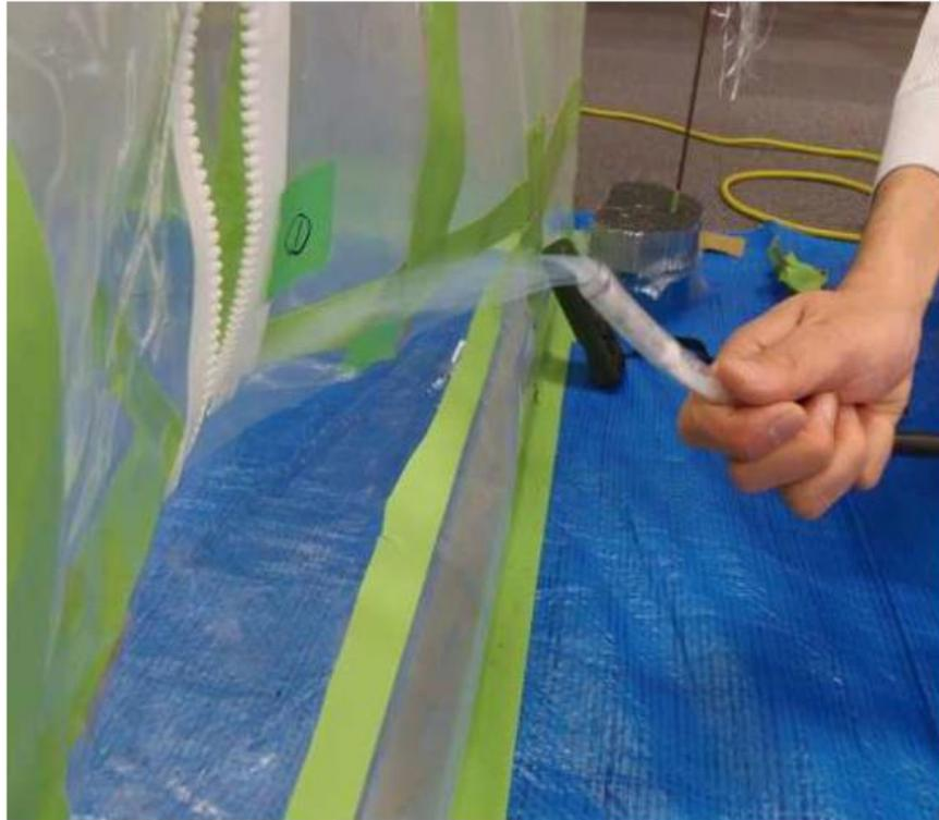
図 3. 121 スモークテスターによる確認
