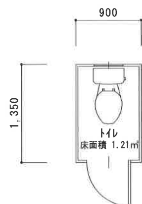
トイレ平面図 S=1/50 軽量形鋼造 1階建
