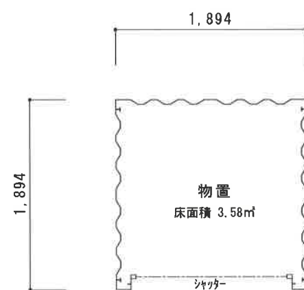
物置平面図 S=1/50 スチール折板構造 1階建
