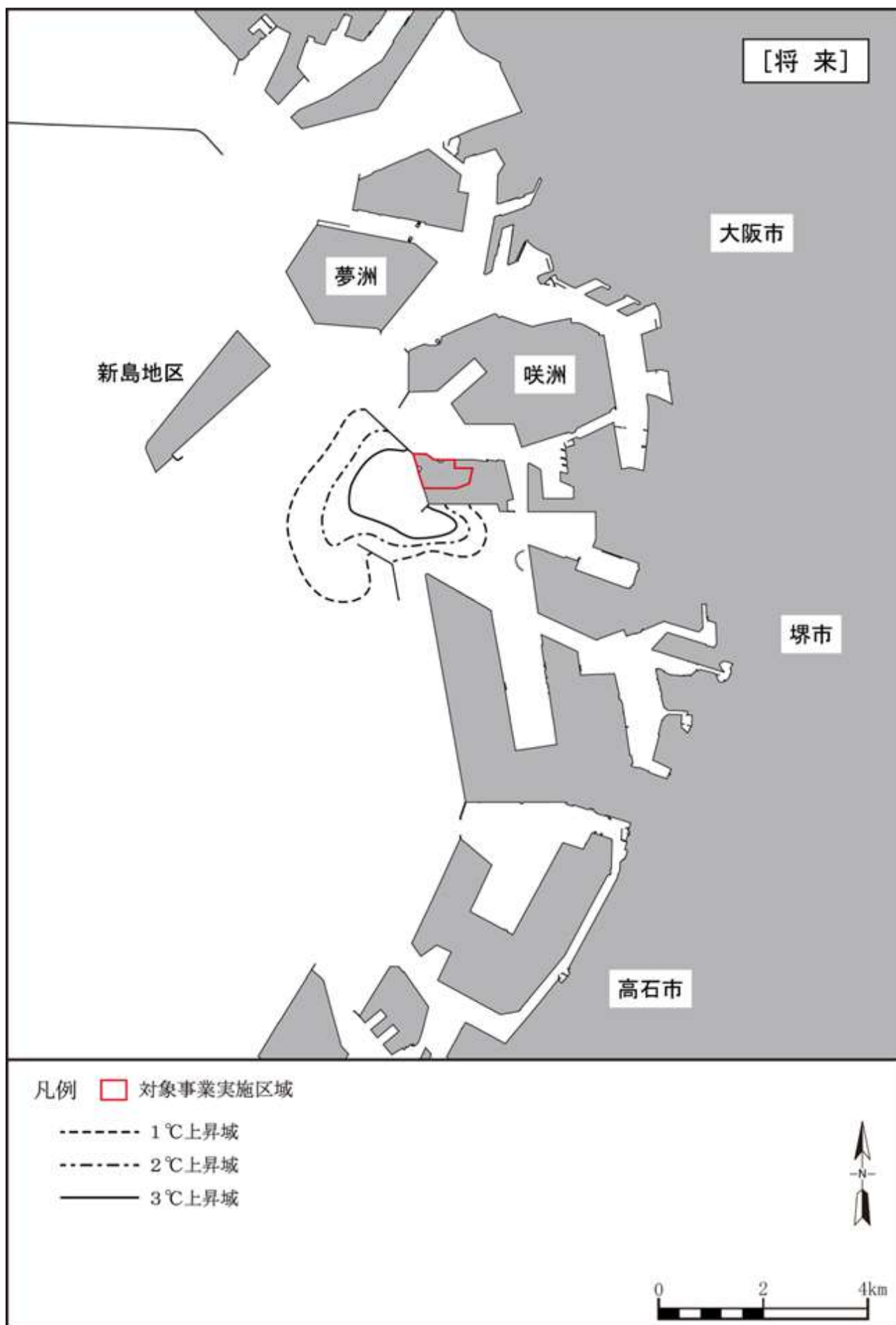
図Ⅱ-3-14(4) 温排水拡散予測結果（包絡線、海面下1m、将来）（準備書から引用）
