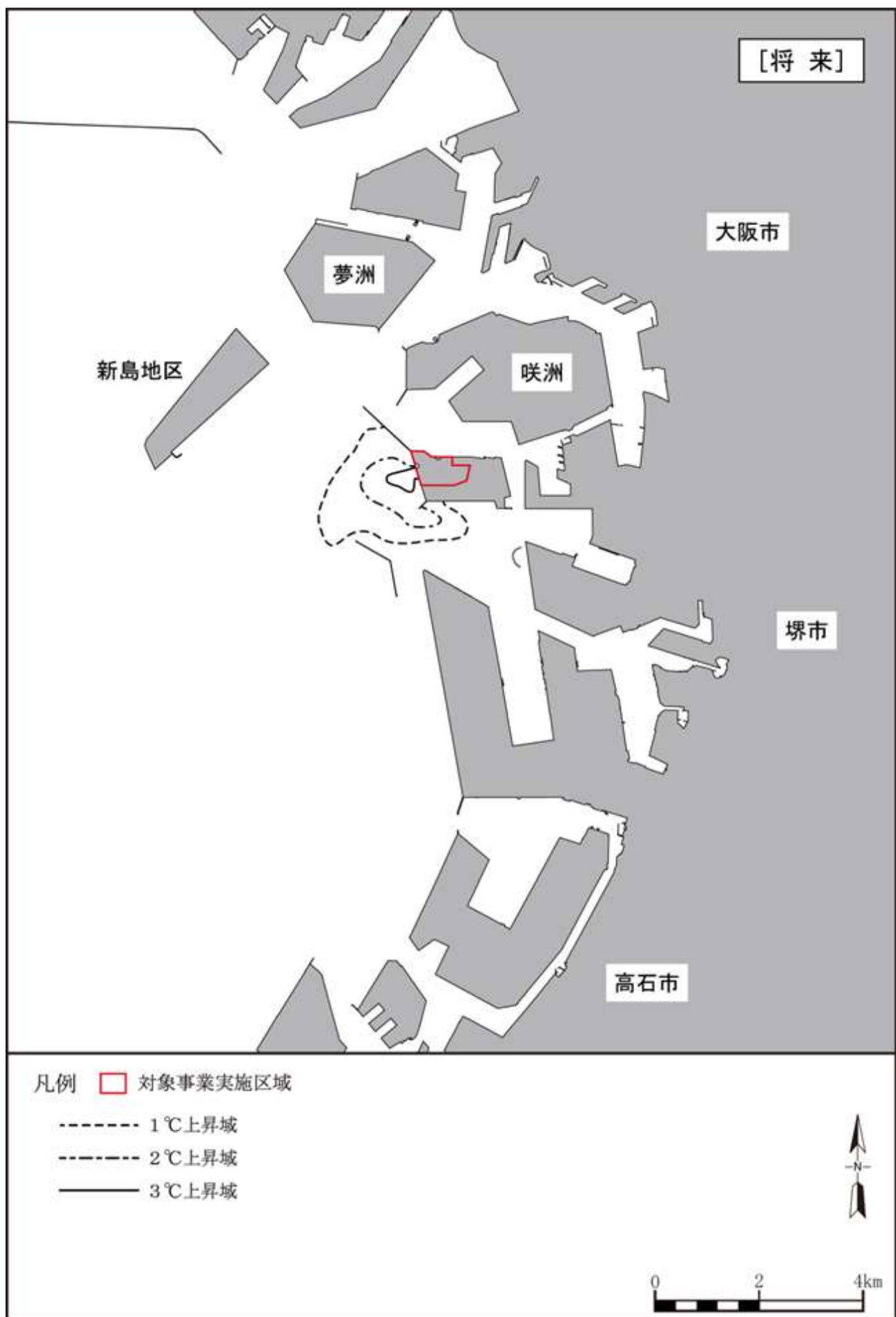
図Ⅱ-3-14(6) 温排水拡散予測結果（包絡線、海面下2m、将来）（準備書から引用）
