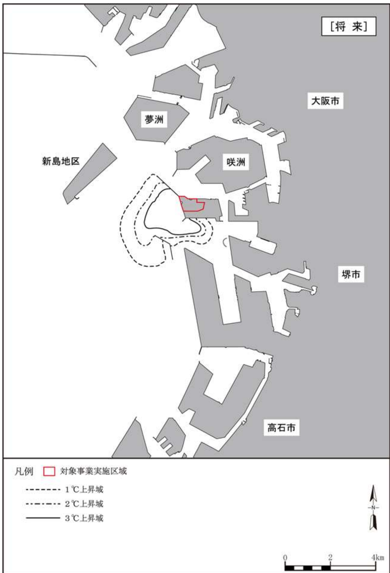
図Ⅱ-3-14(2) 温排水拡散予測結果（包絡線、海表面、将来）（準備書から引用）
