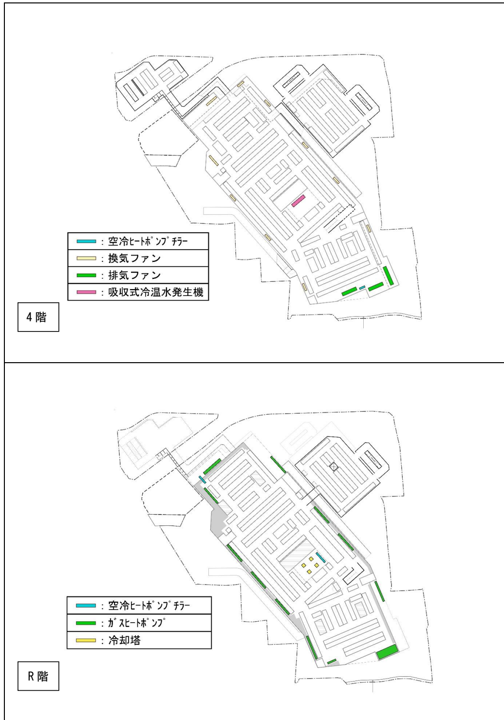
図 II-3-4-6 設備機器の配置
