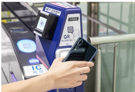
図表 Visa等のタッチ決済用とQRコードリーダーを搭載した改札機
