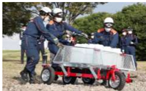
堺市が民間企業と開発中の消防防災活動における重量資器材搬送などの支援用電動アシスト自転車
