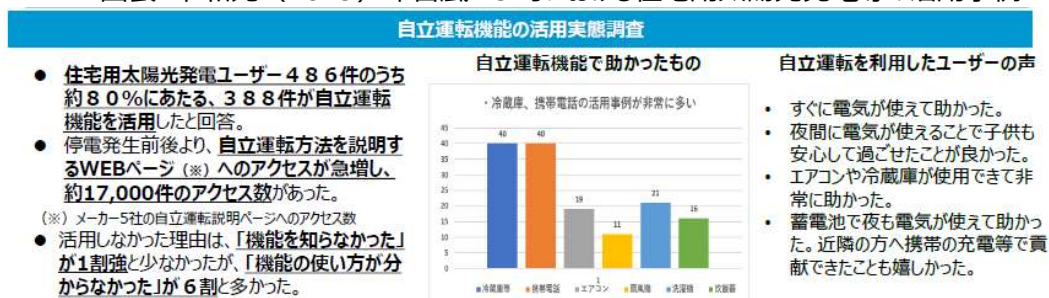
図表 令和元（2019）年台風 15 号における住宅用太陽光発電等の活用事例
