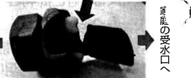
事故現場の給水管損傷状況 →給水管が割け、ここから漏水した水と周りの砂などが流れる力で、金属部品が徐々に削り取られている。
