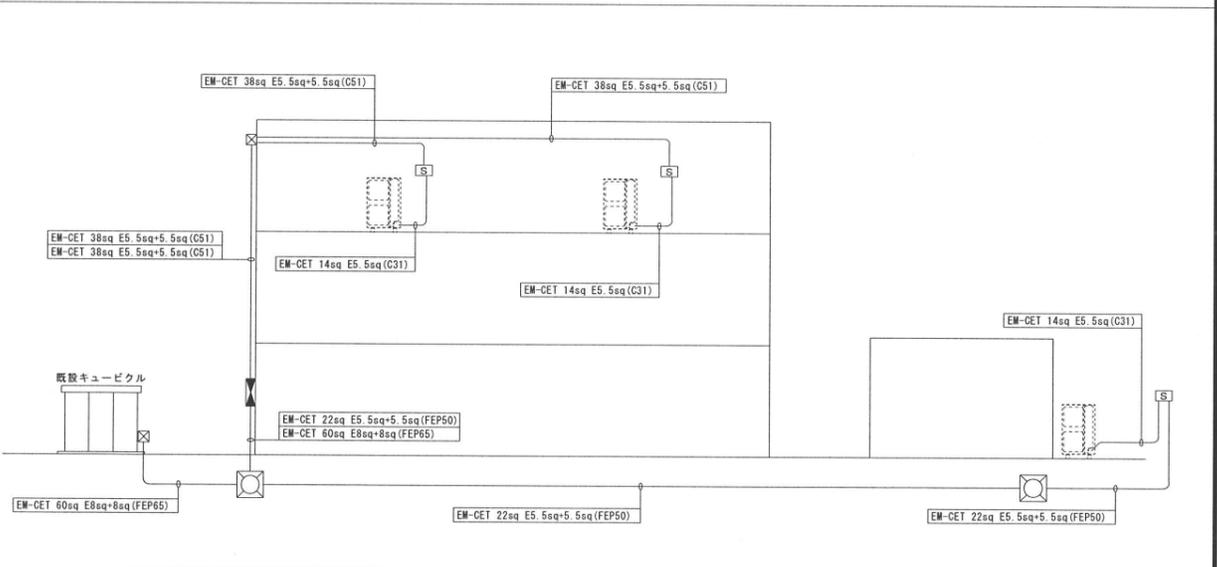
新設空調盤 (AC-2) 結線図
