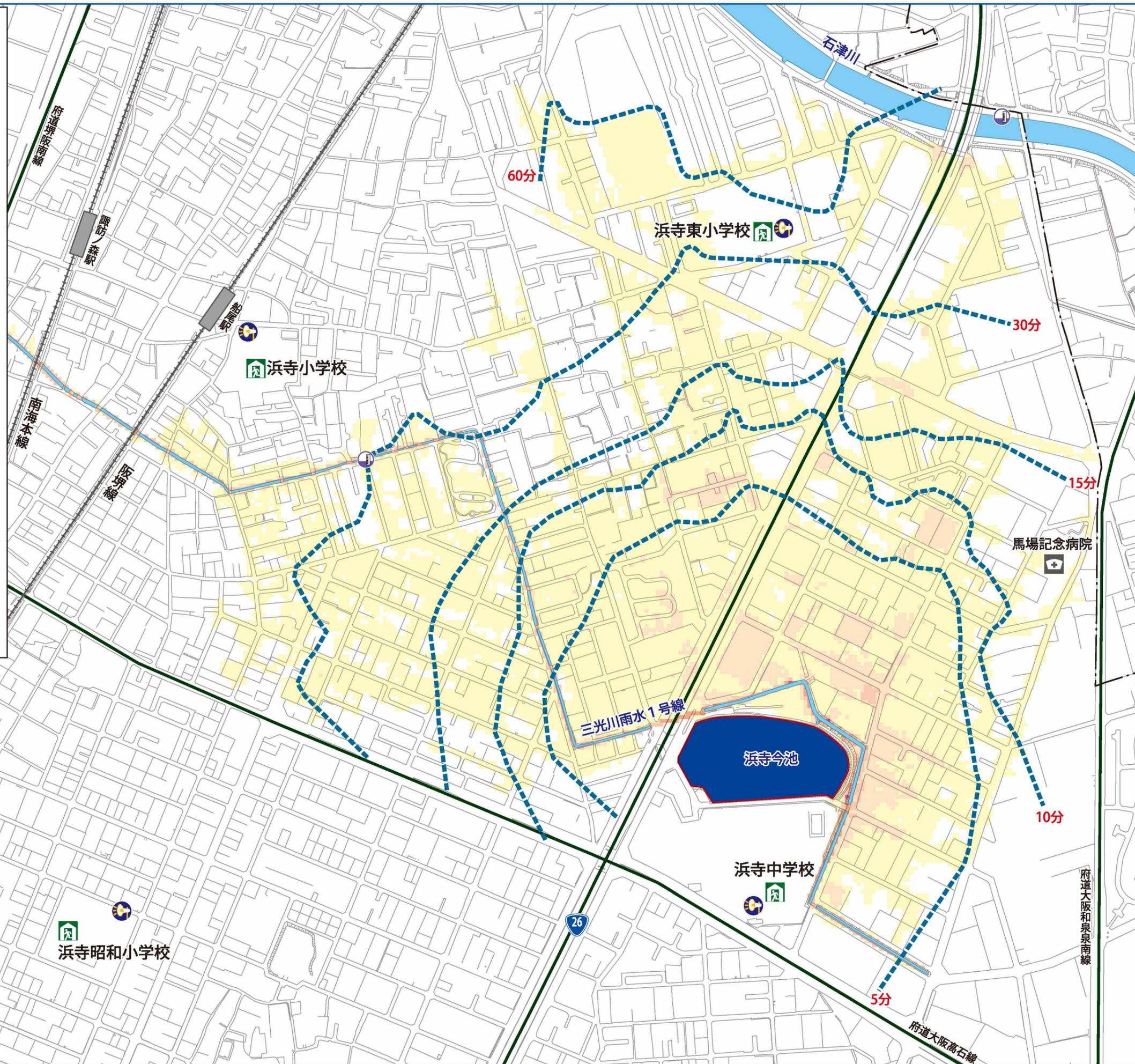
このため池ハザードマップは、貯水量が満水の状態で堤体が全壊した場合のシミュレーション結果を示しています。また実際の浸水範囲は、決壊時の貯水量や堤体の被害の程度、周辺の土地利用状況により変わる可能性があります。
