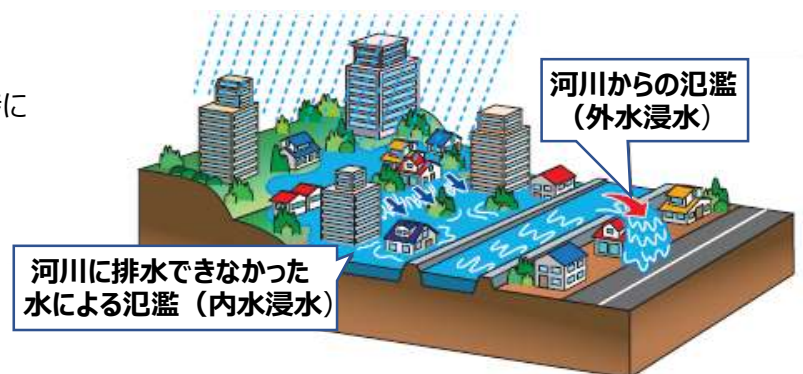
図 1. 雨水出水（内水浸水）と洪水（外水浸水）のイメージ図
