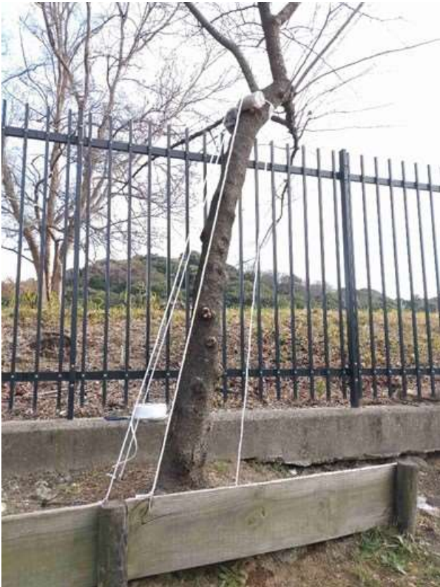
紐フレームの例。紐自身を詰め物で浮かせている。地面への固定は目串で行っている（写真は便宜上白色の紐を使用している）。
