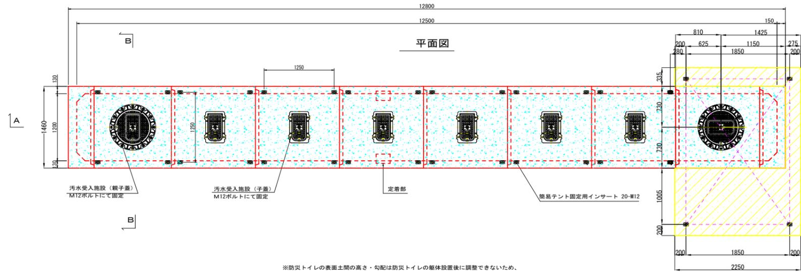
※防災トイレの表面土間の高さ・勾配は防災トイレの整体設置後に調整できないため、表面に水が溜まらないように、また周辺地盤との大きな段差が生じないように、現状高さより計画仕上がり高さを考慮したうえで防災トイレの設置を行う。
