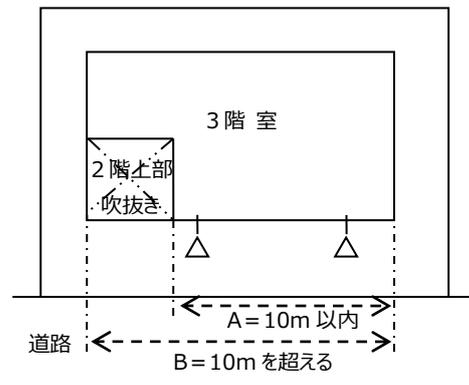
代替進入口が必要な外壁面はBの部分であり、Bの部分に長さ10m以内ごとに代替進入口を設けなければならない。
