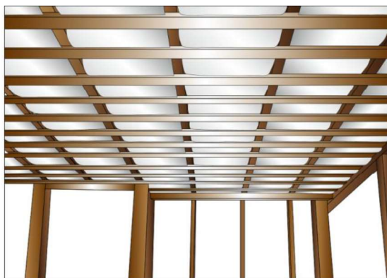
6. 天井(屋根)断熱材 (居間)
