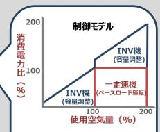
容量調整は常にINV機で行い 負荷率が大きくなるときのみ 一定速機が全負荷で運転する ように設定圧力を調整!
