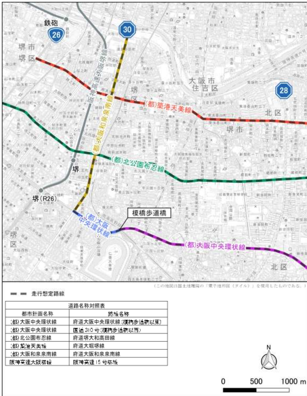
図 I-4-7 工事車両の走行路線図（想定）
