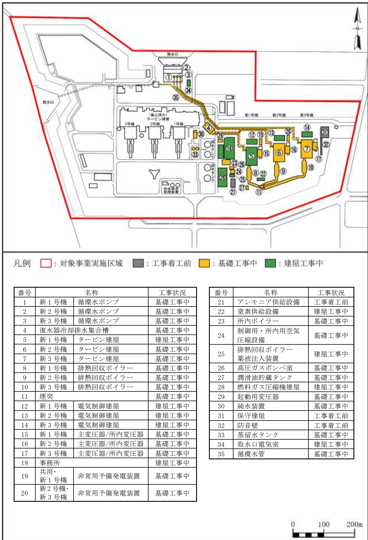
図 I-6-4(2) 主要な工事の施工手順 (工事開始後 21 ヶ月目)
