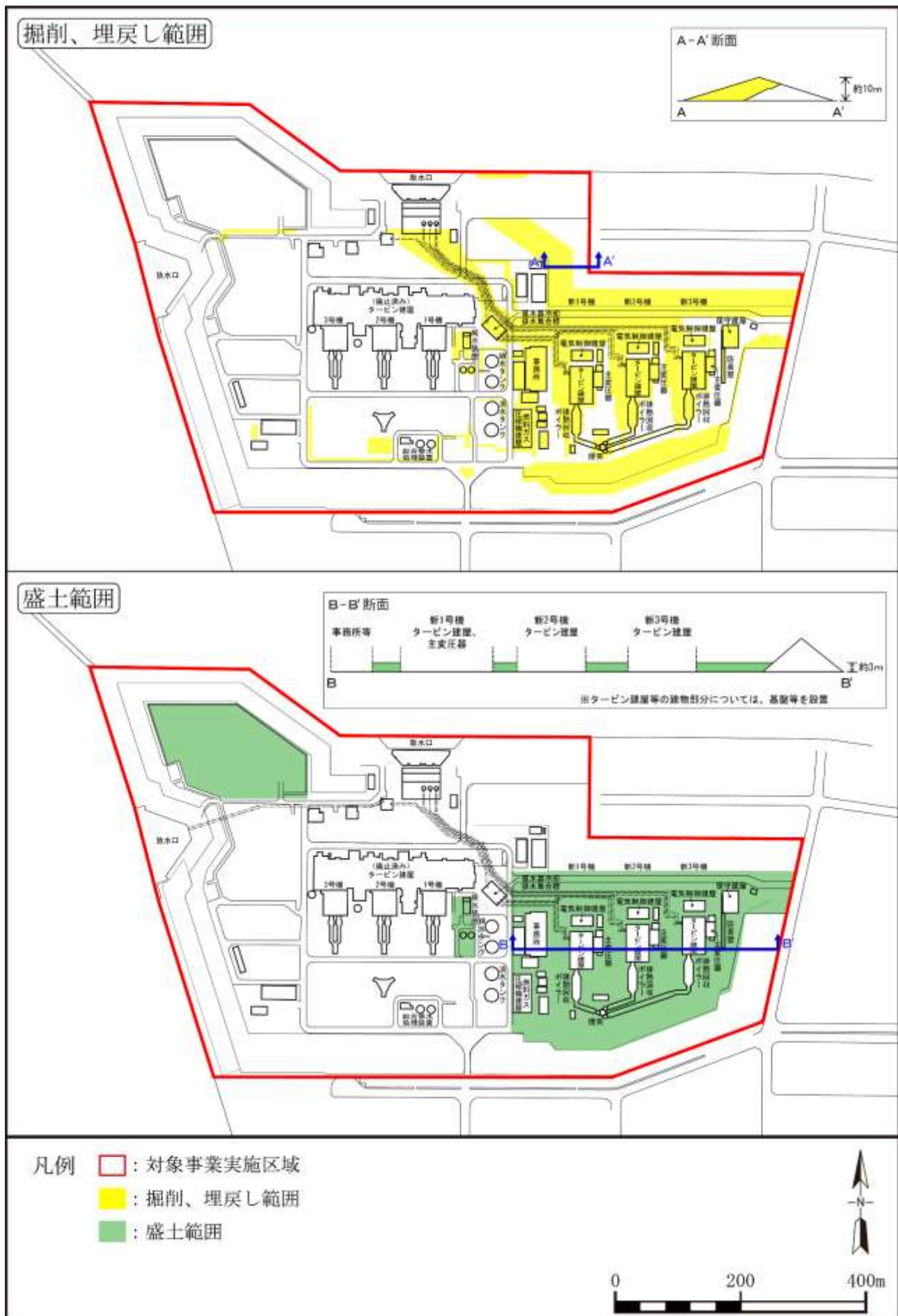
図 I-6-8 掘削、埋戻し及び盛土の範囲
