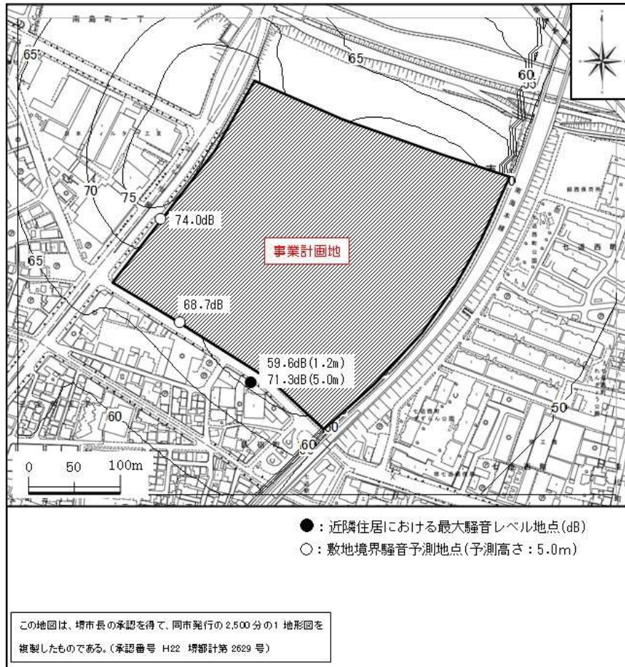
図 3-3-2-5 建設作業騒音の予測結果(工事開始より4ヶ月目)
