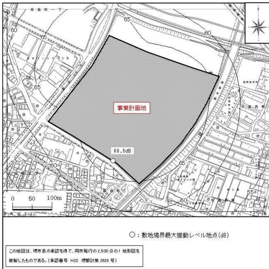
図 3-3-3-2 建設作業振動の予測結果（工事開始より4ヶ月目）
