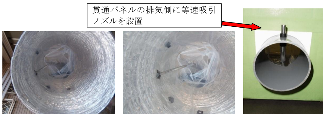
図4.14.17 等速吸引ノズルを使用した場合の排気ダクト内の測定例
