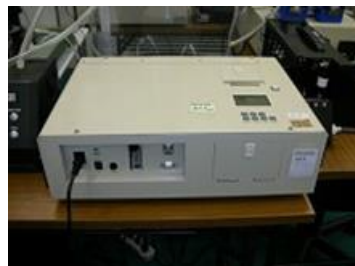
図4.14.4 繊維状粒子自動計測器の例（2）
