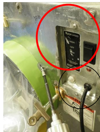
図 4.7.55 電源コード取り付け部 ダクト接続口
