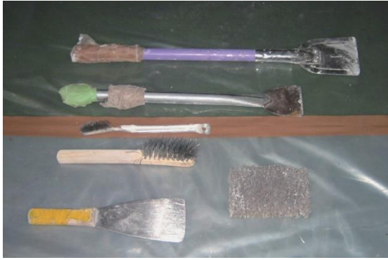
図 4.7.58 除去作業用の手工具の例
