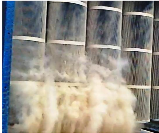
写真Ⅲ－３ フィルタ自動再生状況
