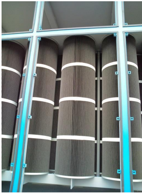
写真Ⅲ－２ プリーツ成形フィルタの例
