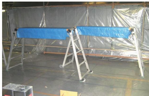
図 4.7.57 可搬式作業台の例
