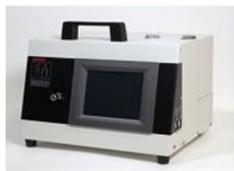
図4.14.4 繊維状粒子自動計測器の例（1）
