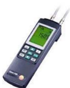
図4.14.5 マイクロマンومتر（精密微差圧計）例
