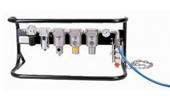
図6.2.10 空気清浄装置の例
