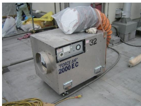
図 4.7.35 集じん・排気装置の例
