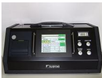
図4.14.4 繊維状粒子自動計測器の例（2）
