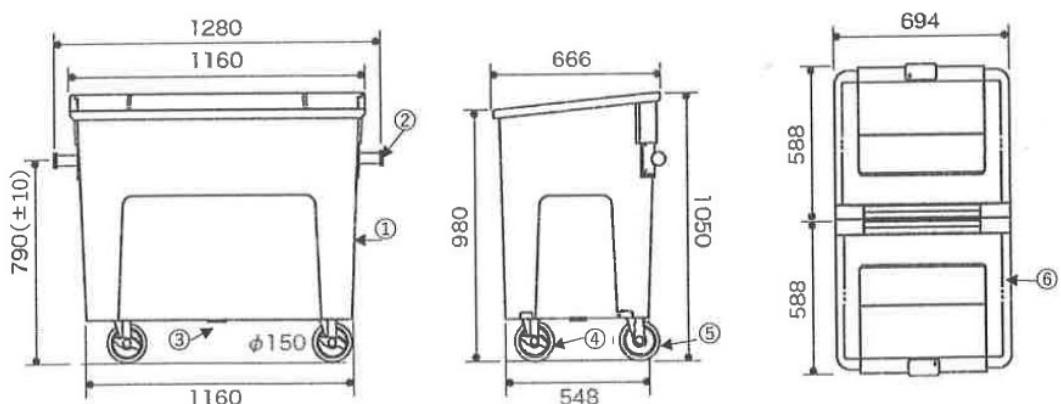
① 本体 ②パイプ ③汚水抜キャップ ④車輪 ⑤車輪 (ブレーキ付き) ⑥蓋
