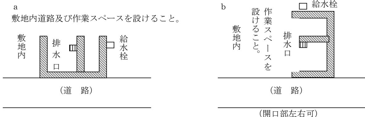
別図第4 コンテナボックス集積場の例
