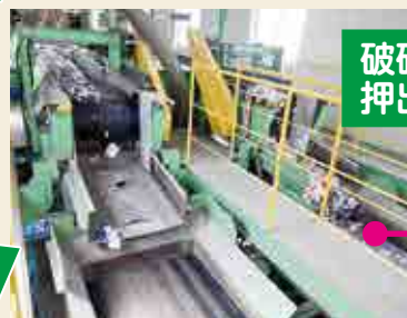
破砕・手選別・光学（機械）選別により異物除去
