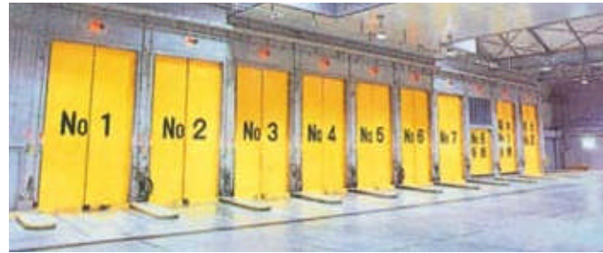
■プラットフォーム ごみ収集車が計量機で重さを量ってからプラットフォームに入り、投入扉からごみピットにごみを投入します。
