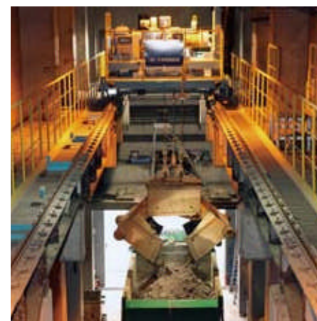
■灰クレーン 焼却灰と処理された集じん灰を灰積出車へ積み込みます。
