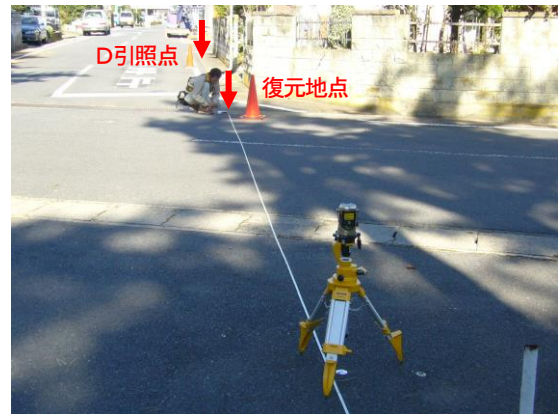
C引照点での基準器による視準(C引照点～復元地点～D引照点)
