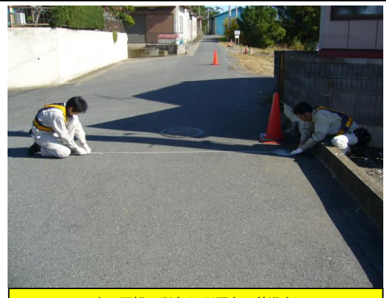
水平距離の測定(D引照点～基準点)
