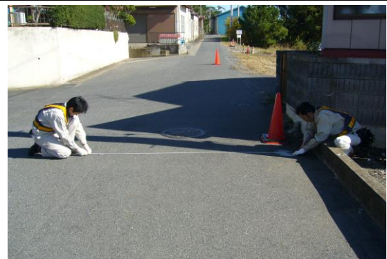
水平距離の測定(D引照点～基準点)
