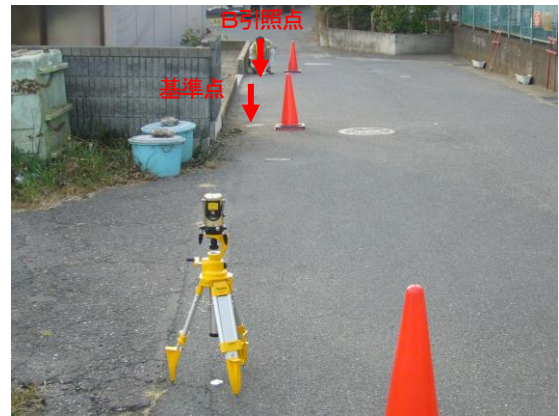
A引照点での基準器による視準(A引照点～基準点～B引照点)
