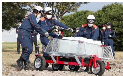
堺市が民間企業と開発中の消防防災活動における重量資器材搬送などの支援用電動アシスト自転車
