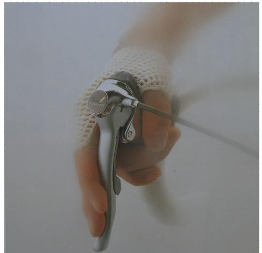
新しい部品開発(ブレーキと変速レバーの一体化)
