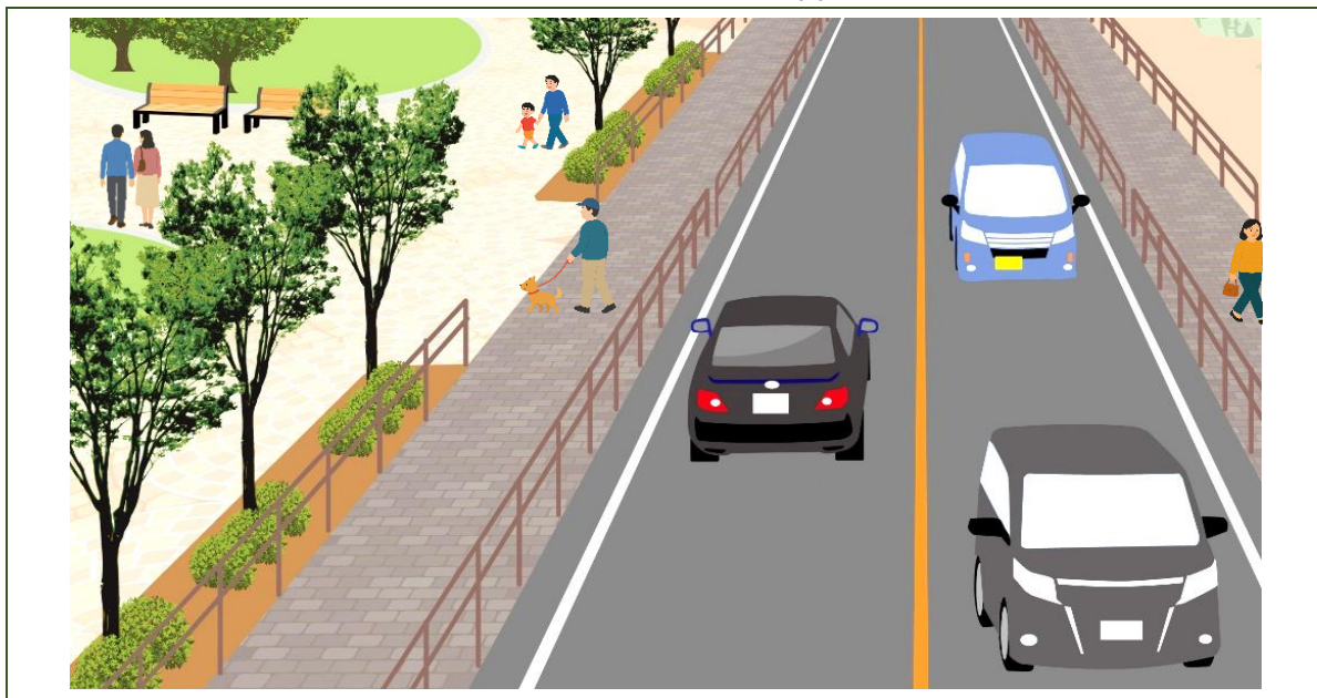
図 4-4 取組イメージ（周辺の植栽環境を踏まえた街路樹の撤去により歩道幅員を確保）
