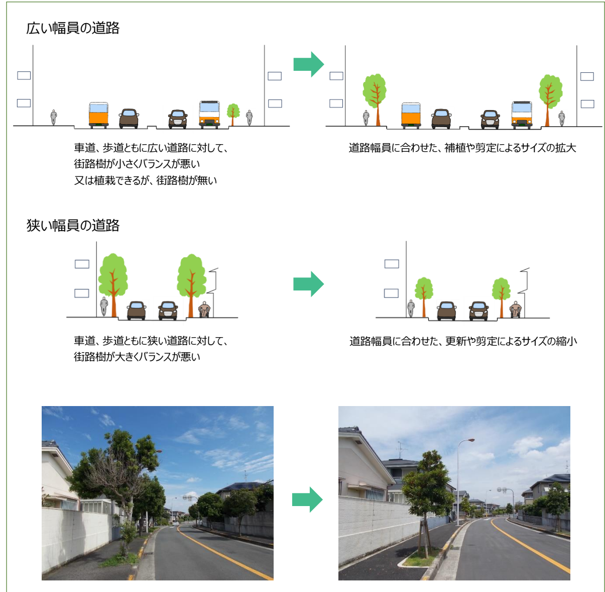
図 3-8 道路空間に合わせたサイズ、樹形の見直しのイメージ
