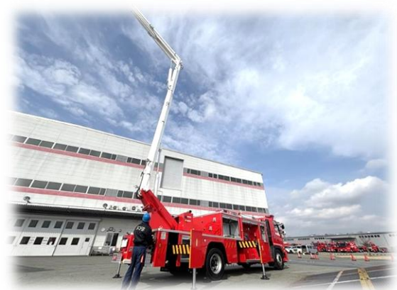
分解修理（オーバーホール）を実施した大型高所放水車の整備箇所の確認や塔の動作確認を行う様子
