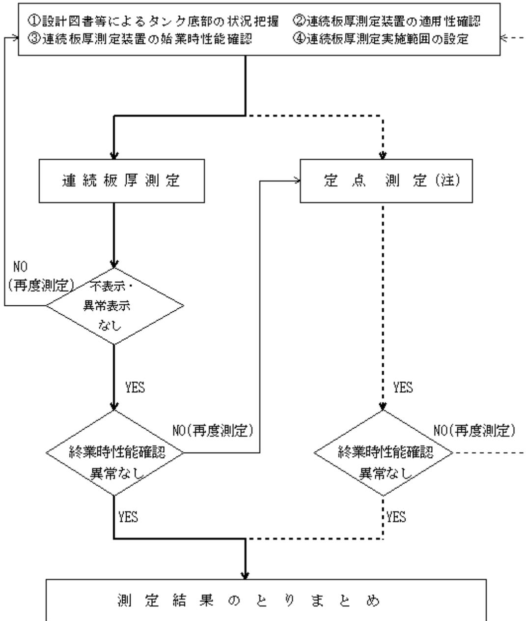
(注) 連続板厚測定装置の性能確認等を行った上で所定の性能が確認できない場合、又は連続板厚測定装置により測定ができない箇所にあつては、定点測定法による板厚測定を実施すること。
