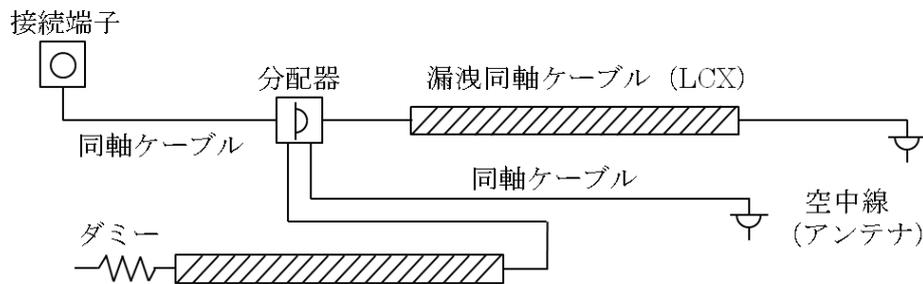
LCX方式とアンテナ方式の特徴を組合せたものである。
