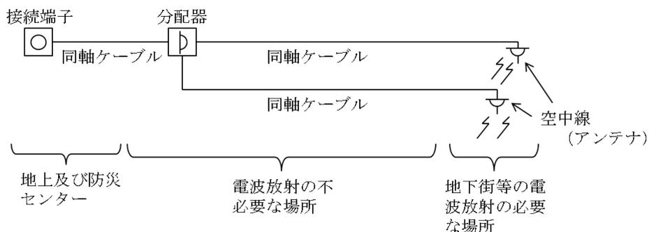
ホール、コンコース等の比較的障害物の少ない広い空間のある場所に適している。LCXより経済的な面もある。同軸ケーブル部分はコンクリート等に埋設できる。
