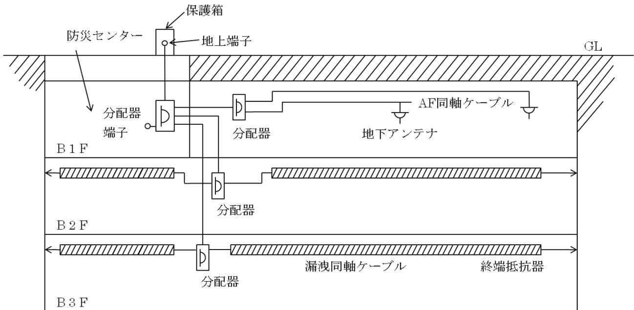
第24-1図 無線通信補助設備の構成例
