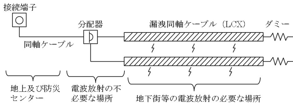
トンネルのような細長い建造物の内部等電波伝播の悪いところでも均一な電波エネルギー (電界) を放射できる。
