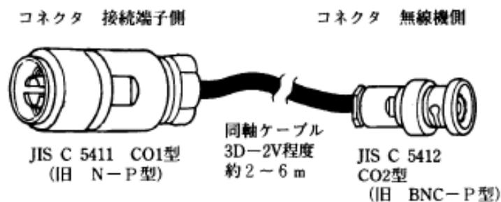
第 2 4-6 図 接続用の同軸ケーブル外観図
