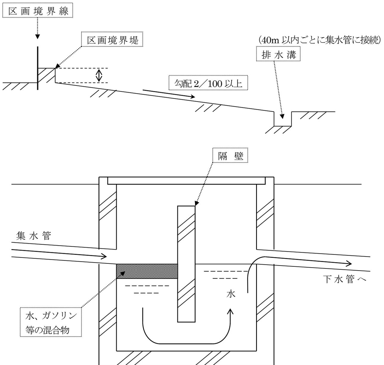
第5-3図 排水設備の構造例
