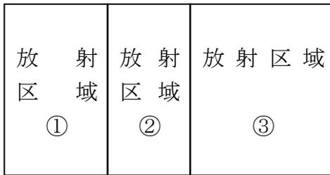
隣接する放射区域のうち、①+②と②+③とを比較し、隣接する大なる方を消火剤の貯蔵量とすることができる。
