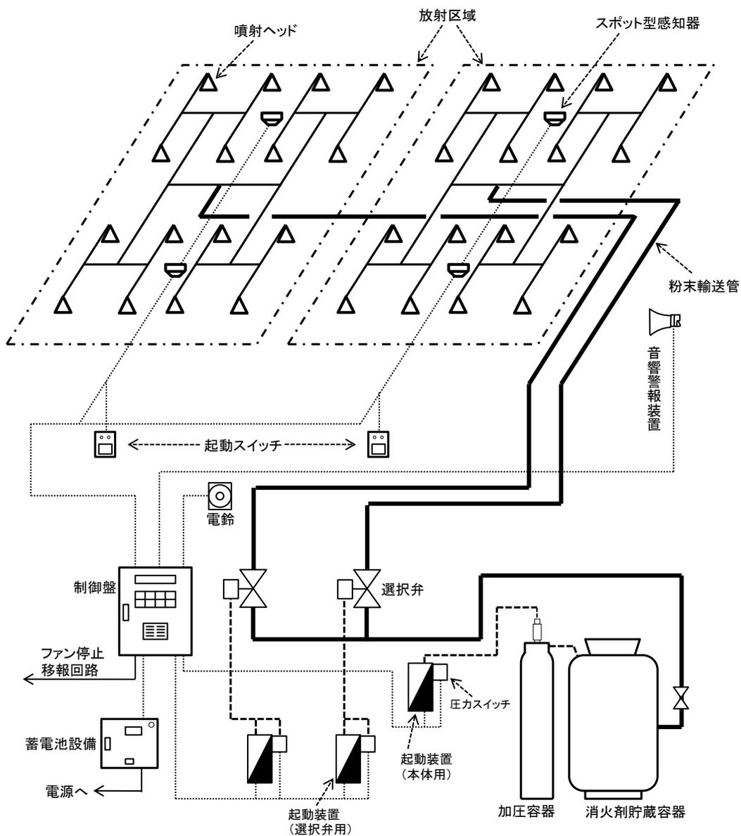
第9-2図 粉末消火設備の系統図例
