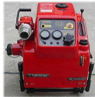
可搬消防ポンプ
